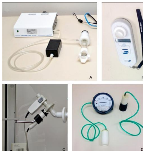
Figura 1. Diferentes equipos para medir P_{i_{max}} - P_{e_{max}} . A) Equipo Sibelméd DATOS-PIR-120 PIM-PEM®. B) Carefusion MicroRPM®. C) MasterScreen PFT Jaeger® y D) Paul-Enright®.
