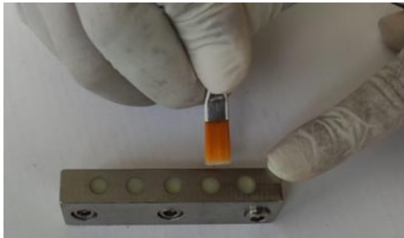
IMAGEN 14. Foto polimerización de los cuerpos de prueba resina filtek z350xt 3m espe.
