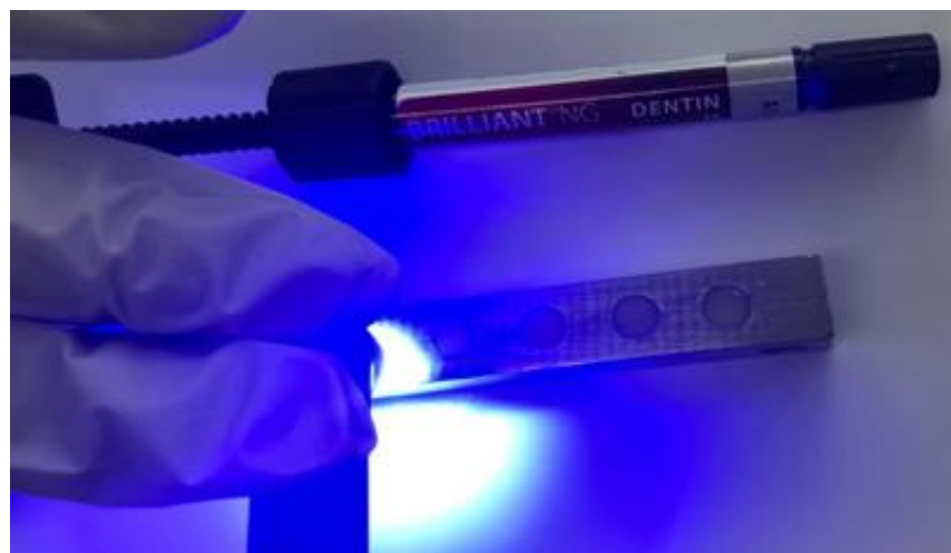
IMAGEN 20. Fotopolimerización de los cuerpos de prueba.
