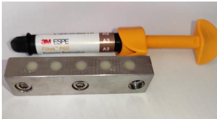
IMAGEN 5. Matriz metálica con cuerpos de prueba y pincel sintético para texturización de resina filtek p60 3m espe.
