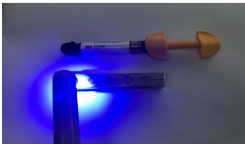
IMAGEN 17. Foto polimerización de los cuerpos de prueba.
