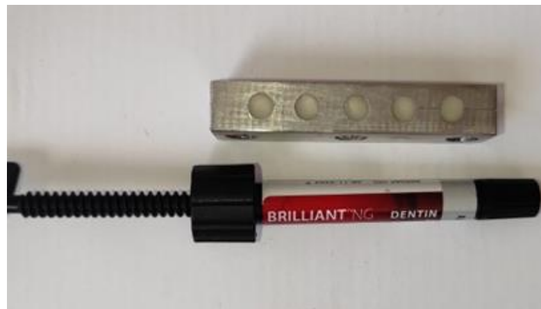
IMAGEN 9. Matriz metálica con cuerpos de prueba y pincel sintético para texturización de resina brilliant ng – coltene.
