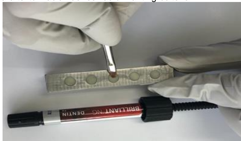
IMAGEN 19. Matriz metálica con cuerpos de prueba y pincel pelo de marta kolinsky para texturización de resinas brilliant ng-coltene.
