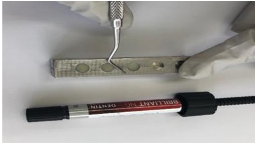
IMAGEN 19. Matriz metálica con cuerpos de prueba y pincel pelo de marta kolinsky para texturización de resinas brilliant ng-coltene.
