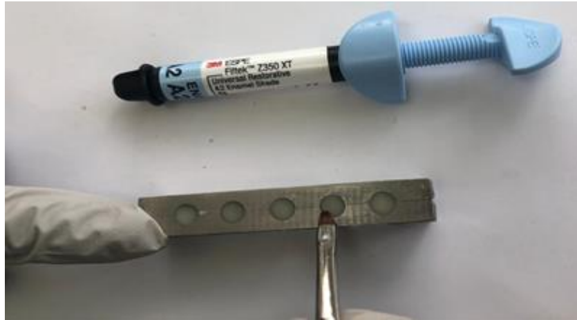
IMAGEN 22. Matriz metálica con cuerpos de prueba y pincel pelo de marta kolinsky para texturización de resina filtek z350xt 3m espe.
