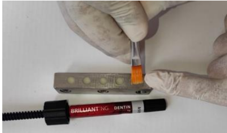
IMAGEN 10. Foto polimerización de los cuerpos de prueba con lámpara.
