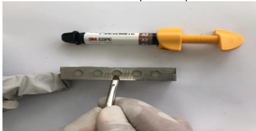
IMAGEN 16. Matriz metálica con cuerpos de prueba y pincel pelo de marta kolinsky para texturización de resina filtek p60 3m espe.
