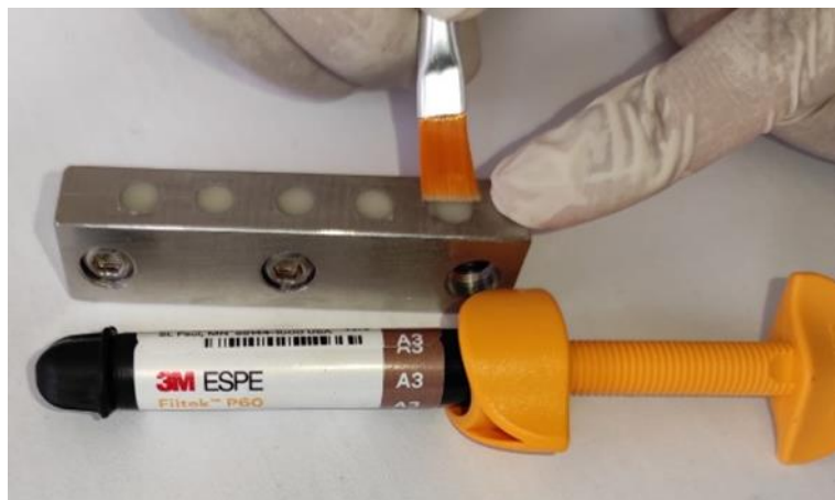
IMAGEN 6. Fotopolimerización de los cuerpos de prueba.
