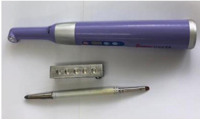
IMAGEN 16. Matriz metálica con cuerpos de prueba y pincel pelo de marta kolinsky para texturización de resina filtek p60 3m espe.
