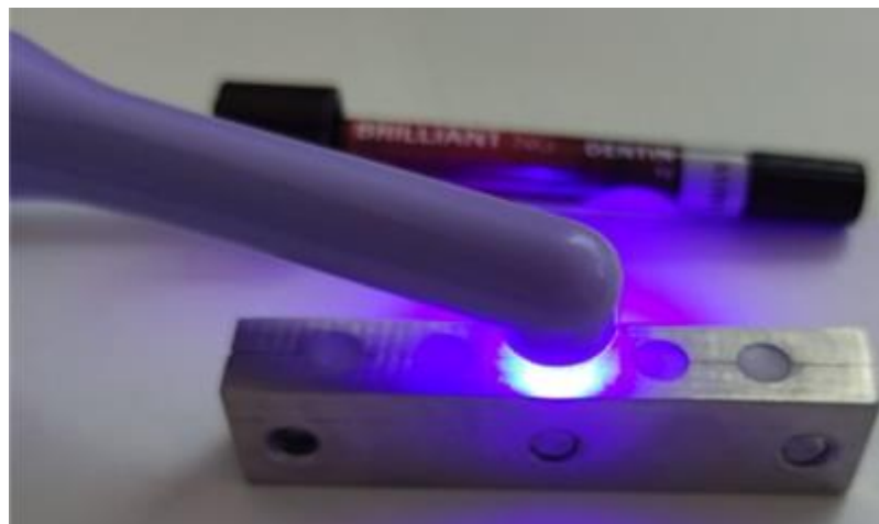
IMAGEN 10. Foto polimerización de los cuerpos de prueba con lámpara.
