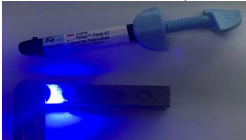
IMAGEN 22. Matriz metálica con cuerpos de prueba y pincel pelo de marta kolinsky para texturización de resina filtek z350xt 3m espe.
