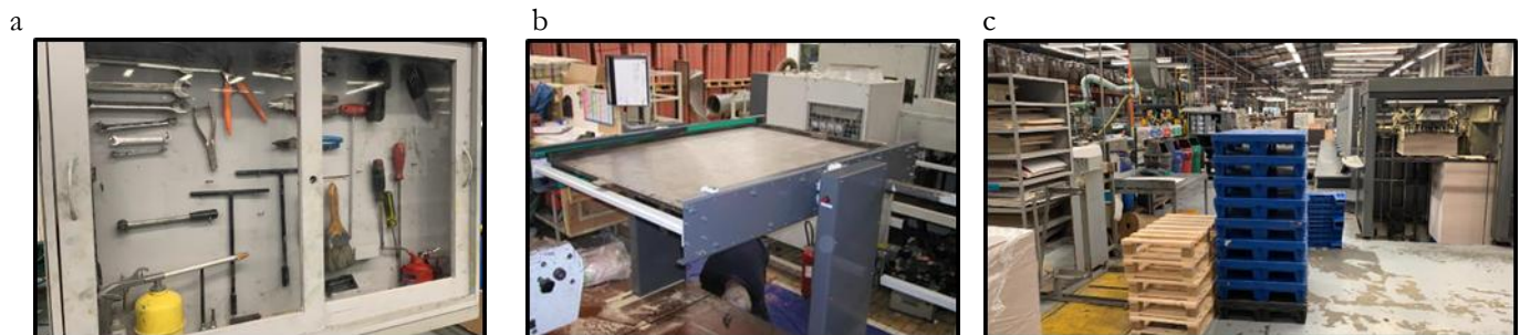
Figura 04. Actualización de herramientas: (a) caja de herramientas; (b) mesa para montaje rápido; (c) demarcación estibas
