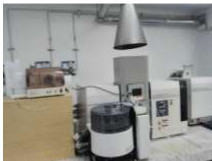
Figura 5. Equipo de absorción atómica para determinación indirecta de metales pesados (Hg y Pb)
