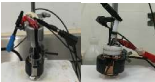
Figura 3. Modificación de electrodos de carbón grafito por reducción electroquímica de 1,10-fenantrolina 50.00mmol L -1 en H 2 SO 4 0.100 mol L -1 a una velocidad de 0.100 Vs -1 con electrodo de carbón vítreo y carbón grafito, \phi = 3 mm.
