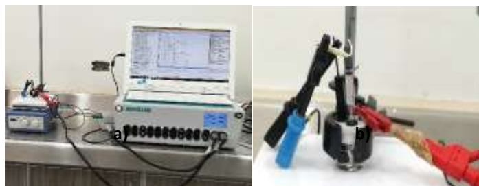
Figura 2. a) Sistema electroquímico de trabajo: celda electroquímica y potenciostato Metrohm Autolab, y b) celda electroquímica para el desarrollo de los experimentos electroquímicos.
