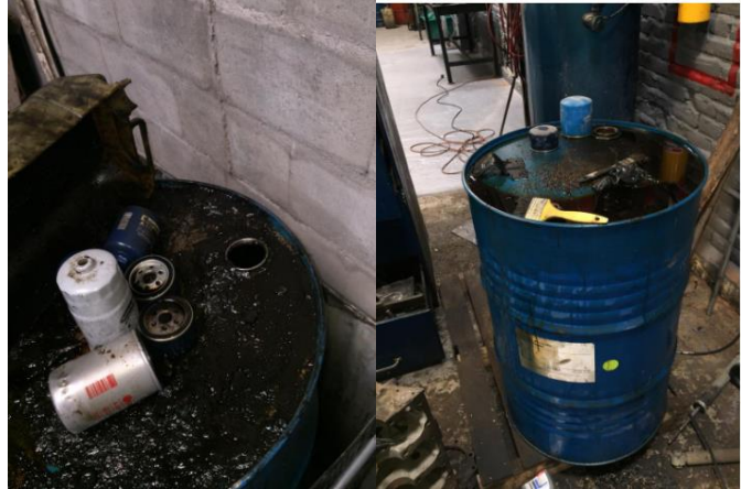
Figura 9. Escurrido de los filtros en el taller REPARAUTOS
