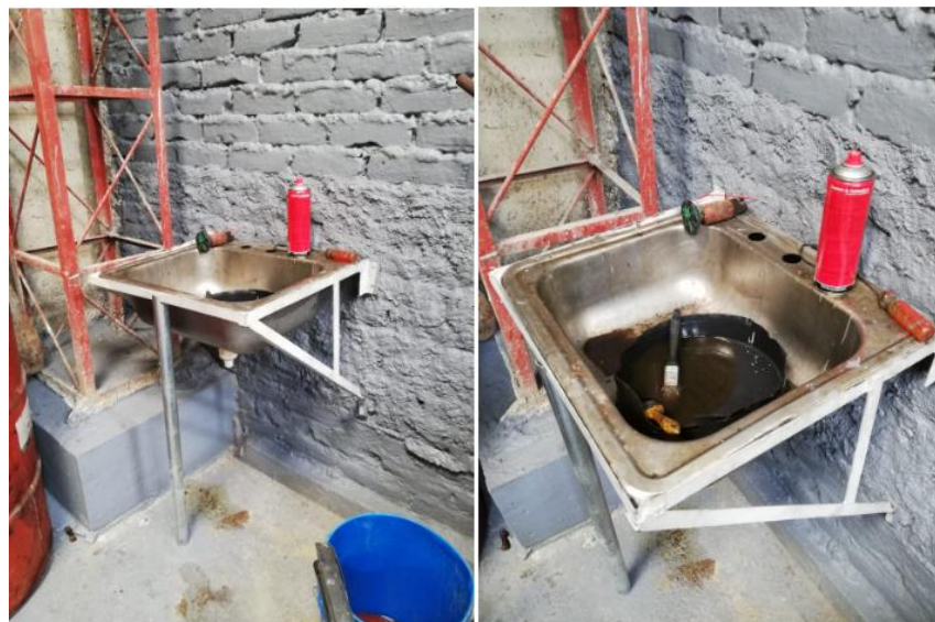
Figura 14. Lavado de partes de vehículos
