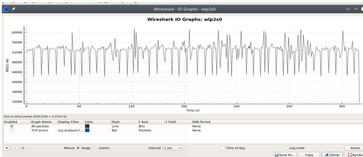
**Figura 16.** Medición en Wireshark del consumo de ancho de banda, adquiriendo 3 señales de derivaciones con frecuencia de 1000 hz.
