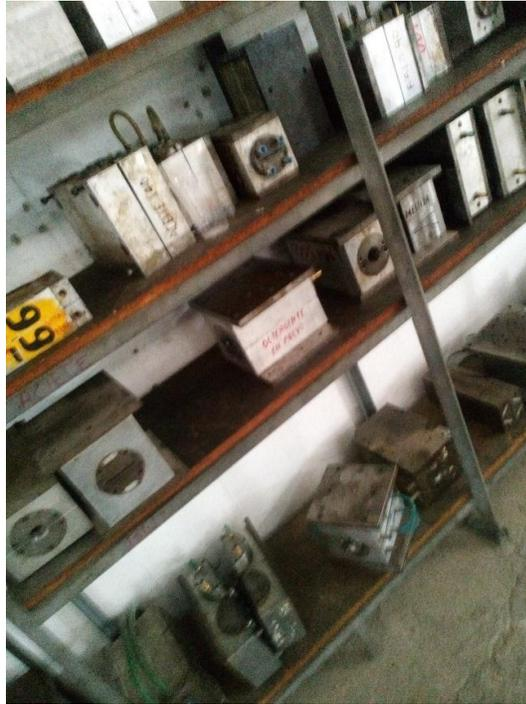
*Imagen 40: Moldes de acero ya hechos para su utilización en la elaboración de botellas plásticas.*
