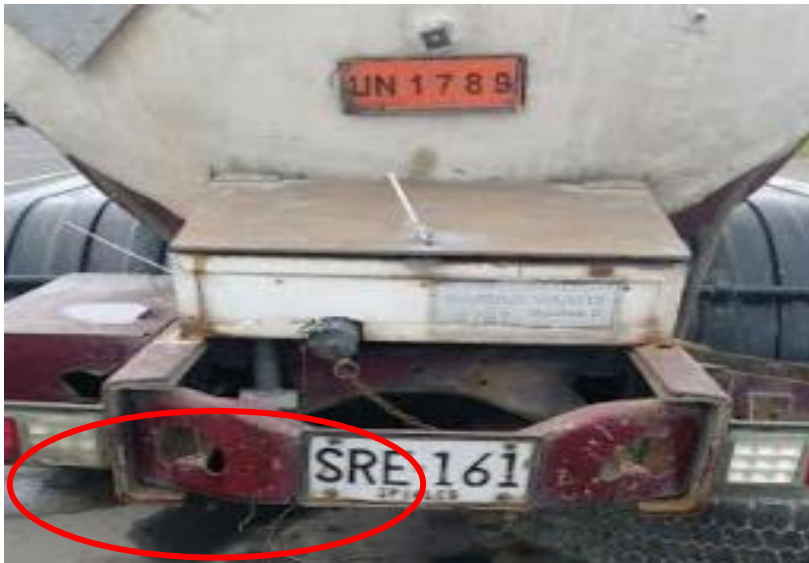
Figura 10. Derrame de HCl al 37% en carrotanque. Parqueadero de Quimicol S.A
