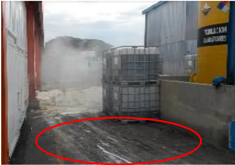
Figura 11. Derrame de HCl al 37% en área de almacenamiento de Quimicol S.A.
