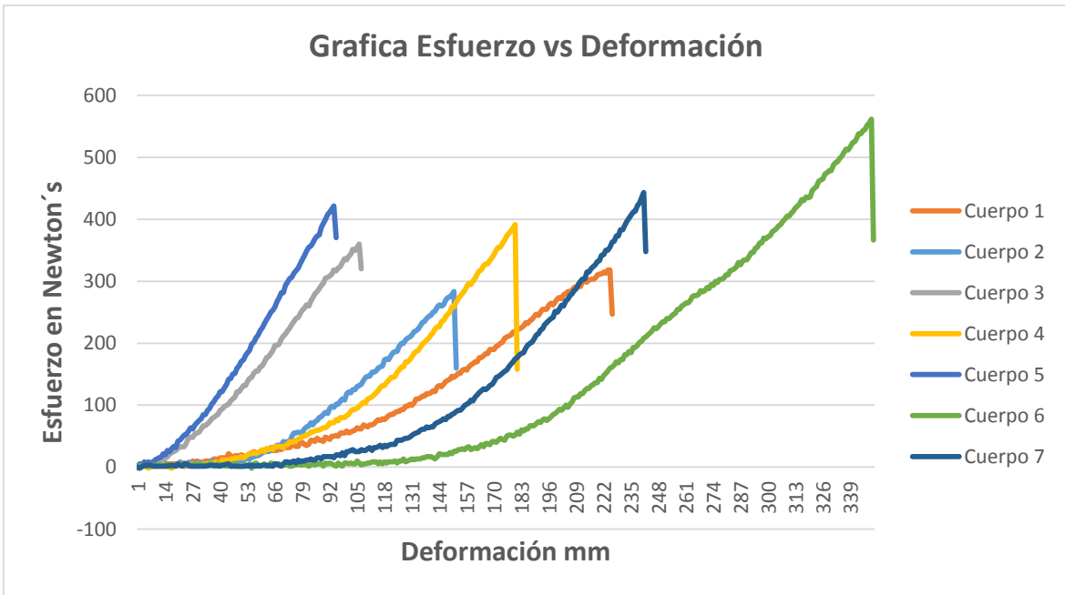
Gráfica 4: Gráfica de Esfuerzo vs deformación de compresión en coronas dentales de 1.0 mm de espesor.
