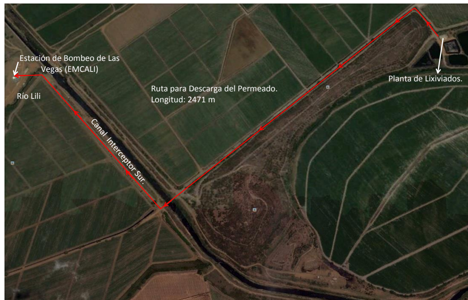
Figura No. 5. Trazado de la Red de Conducción del Efluente de Tratamiento.
