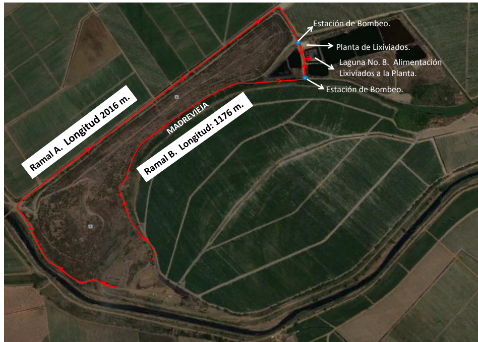
Figura No. 3. Red de Captación de Lixiviados.
