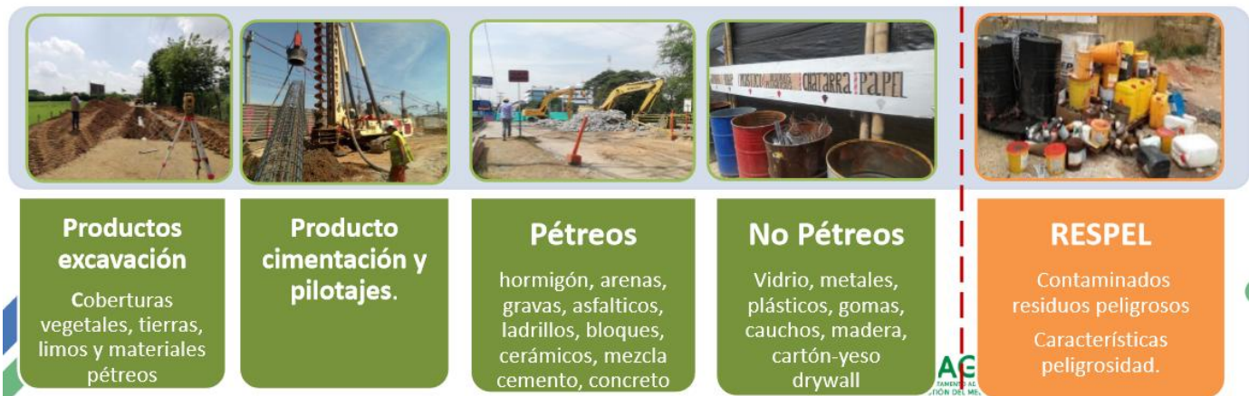
Figura 1. Residuos de construcción y demolición generados durante el proceso constructivo.
