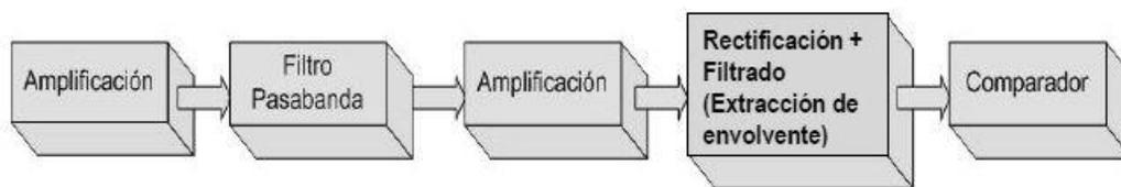
**Figura 3. Diagrama de bloques del circuito de recepción ultrasónica**
