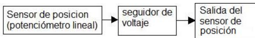
Figura 27. Diagrama de bloques para adecuar la señal de posición
