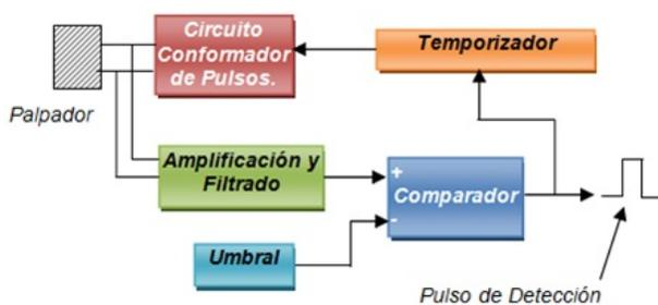
Por su parte, la detección más simple se realiza con el método de umbral, en la cual se obtiene una indicación de eco detectado cuando la señal supera un nivel preestablecido, siendo esta indicación utilizada para marcar
