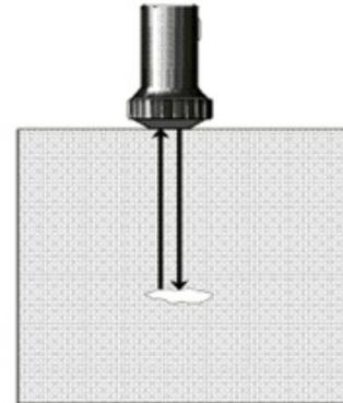
Figura 2. Reflexión no coincidente con el palpador (Berke, 2000)
