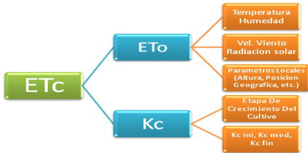
Figura 1. Diagrama para determinar ET_c
