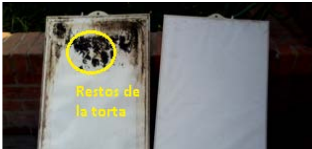
Figura 4. Membrana incrustada después de la operación y membrana nueva
