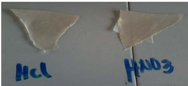
Figura 5. Membrana lavada con ácidos fuertes al 1% seguido de \text{NaClO} al 1%
