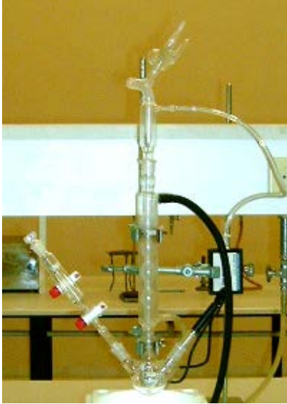
Figura 7. Montaje experimental para la determinación del equilibrio líquido-vapor del sistema n -hexano-ciclohexano
