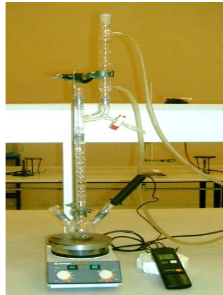
Figura 8. Esquema del montaje experimental para la destilación fraccionada
