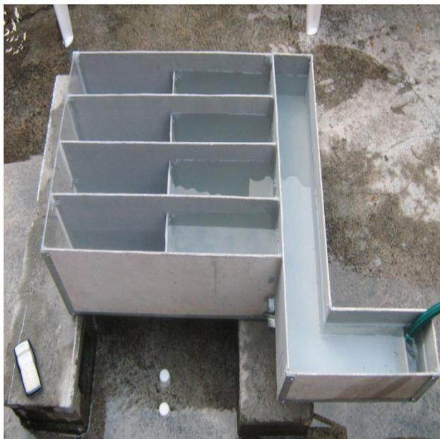
El modelo experimental a escala usado para la investigación permitió analizar la distribución de caudal en un sistema múltiple con cuatro laterales de sección circular con igual área, arrojando diferentes valores de flujo para cada uno de ellos, debido a la disminución gradual del tirante en la medida que se entrega caudal. Los resultados obtenidos de las trece pruebas efectuadas a cada lámina
