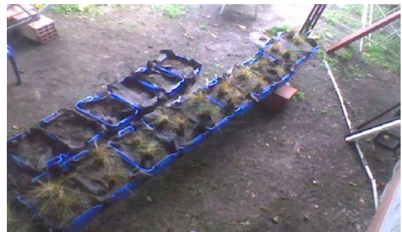
Figura 1. Adecuación del espacio y construcción de los humedales artificiales
